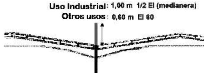
**16.2.** En el encuentro entre una cubierta y una fachada que pertenezcan a sectores de incendio o a edificios diferentes, la altura  $h$  sobre la cubierta a la que deberá estar cualquier zona de fachada cuya *resistencia al fuego* no sea al menos EI 60 será la que se indica, en función de la distancia  $d$  de la fachada (en proyección horizontal) a la que esté cualquier zona de la cubierta cuya *resistencia al fuego* tampoco alcance dicho valor.
